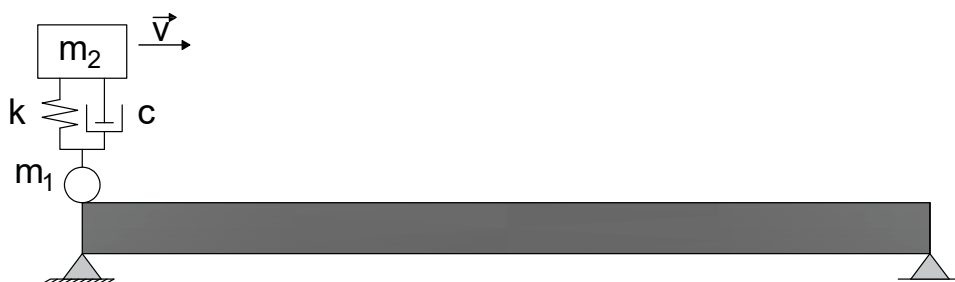
FIGURA 17 – Modelo de veículo com 1 grau de liberdade
