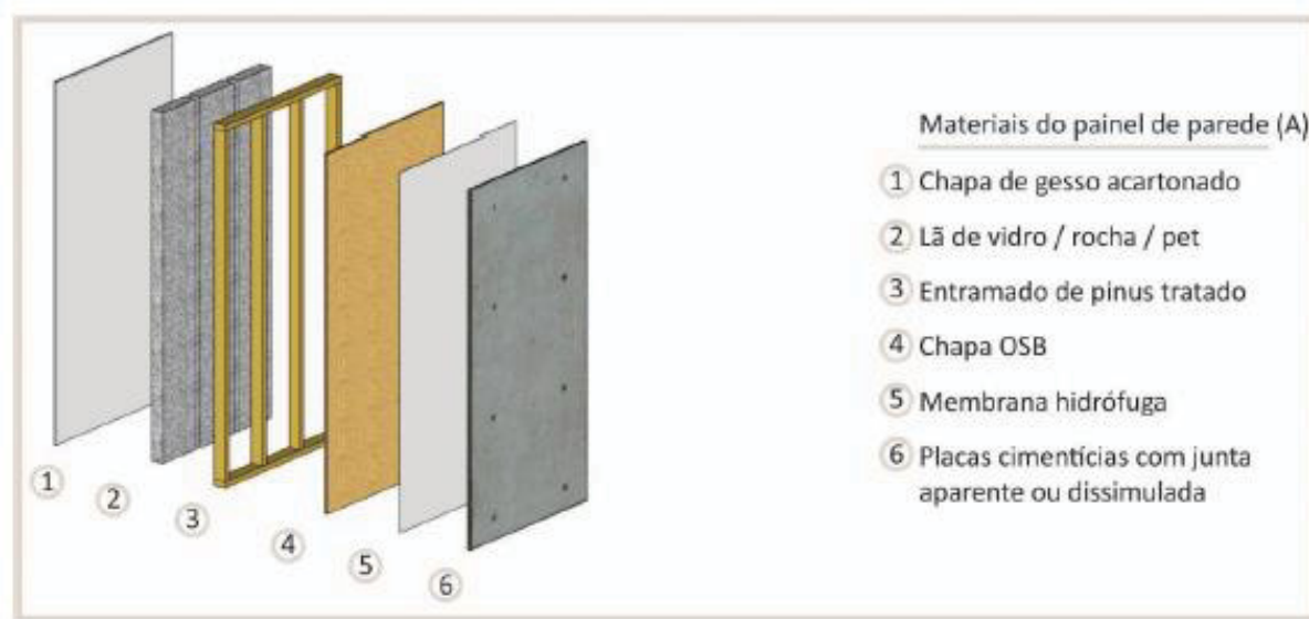
FIGURA 12 - VARIAÇÕES DOS COMPONENTES DO SUBSISTEMA PAREDE
