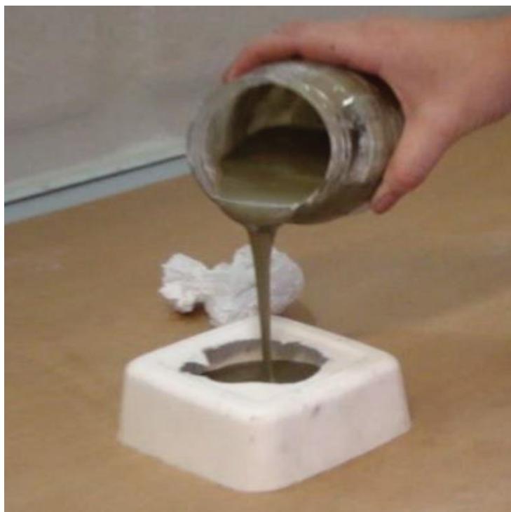
FIGURA 4 - DESPEJANDO A RESINA DE POLIÉSTER AINDA LÍQUIDA, NO MOLDE DE SILICONE
