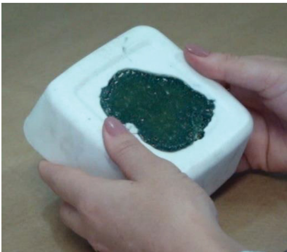
FIGURA 5 - RÉPLICA PRONTA, APÓS 24 HORAS, FEITO COM RESINA DE POLIÉSTER
