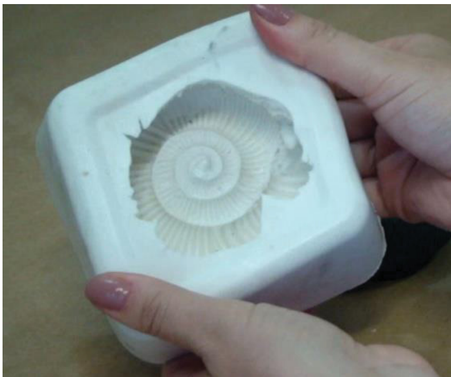
FIGURA 3 - MOLDE PRONTO DEPOIS DE 24 HORAS E DEPOIS DE RETIRADA A PEÇA ORIGINAL
