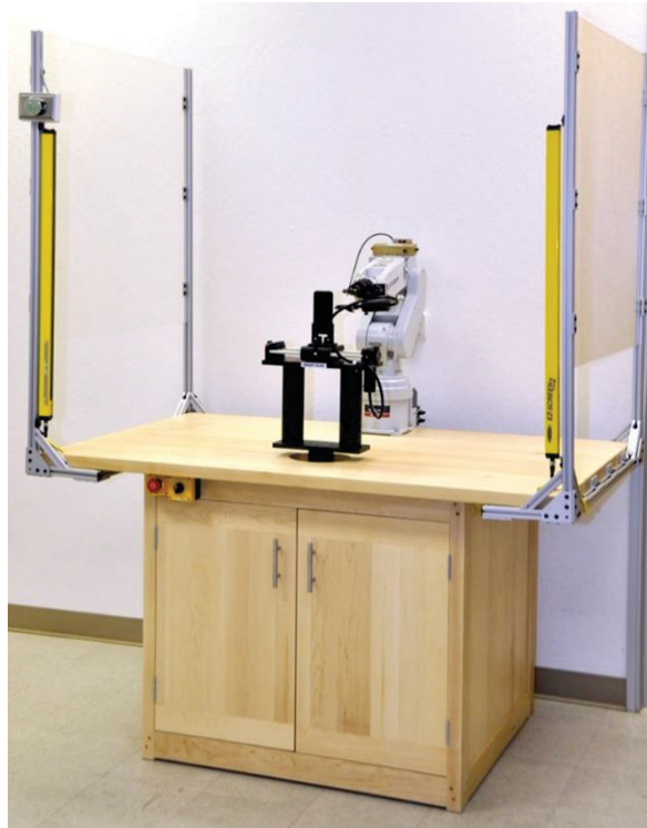
FIGURA 18 – SCANNER RÓBOTICO DE CAMPO PRÓXIMO - API (Scanner robótico para grandes dimensões)
