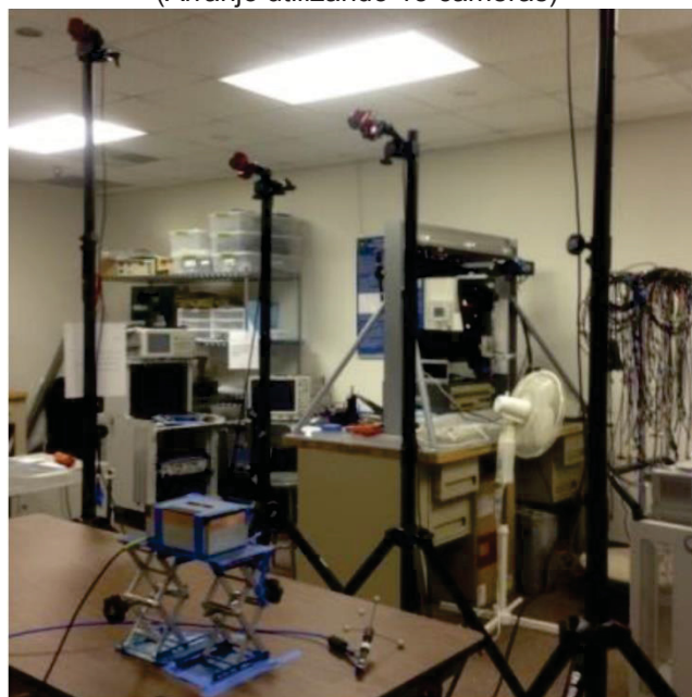
FIGURA 19 – SCANNER MANUAL BASEADO EM POSICIONAMENTO ESPACIAL (Arranjo utilizando 13 câmeras)
