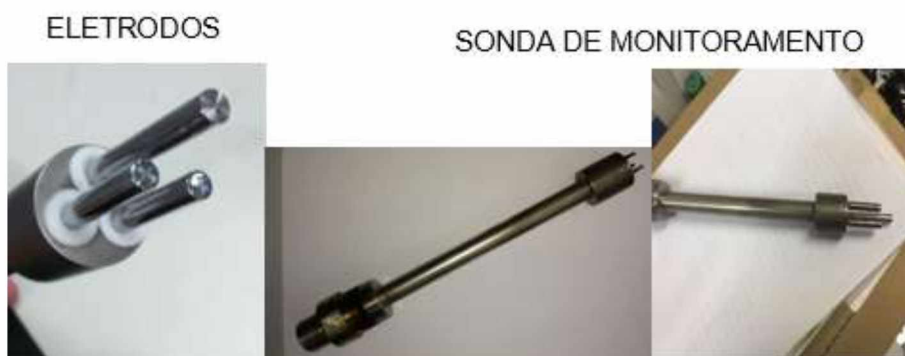
FIGURA 11 – MONTAGEM DOS ELETRODOS NA SONDA DE MONITORAMENTO
