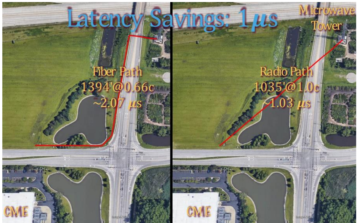
FIGURA 4 – EXEMPLO DE APLICAÇÃO DE CAMINHO ALTERNATIVO VIA MICRO-ONDAS PARA PEQUENA DIMINUIÇÃO DE LATÊNCIA NA ENTRADA DA BOLSA DE CHICAGO.
