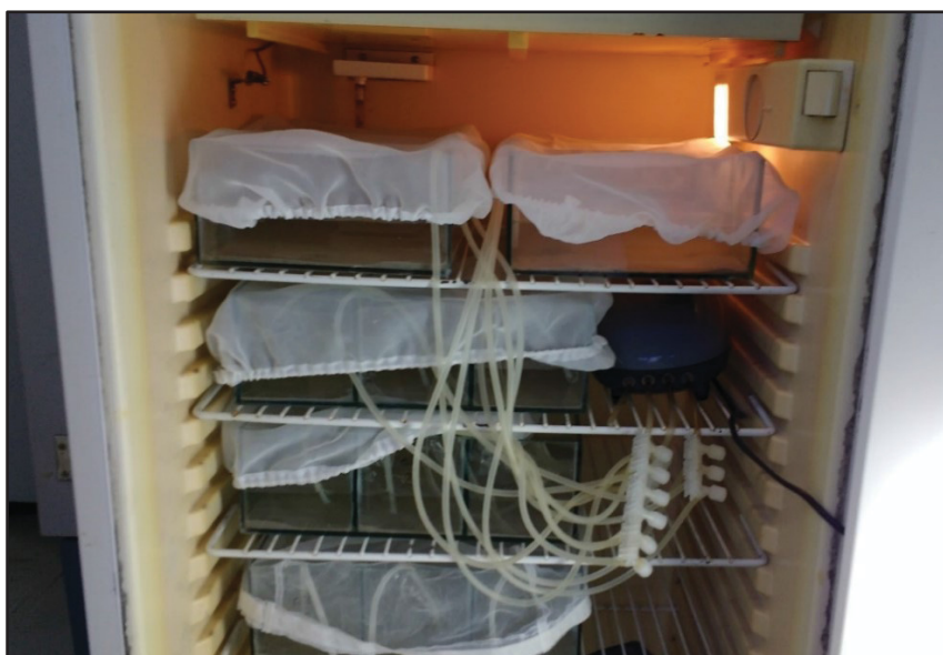
FIGURA 4. Bioensaio crônico, demonstrando os aquários recobertos e bomba de aeração.
