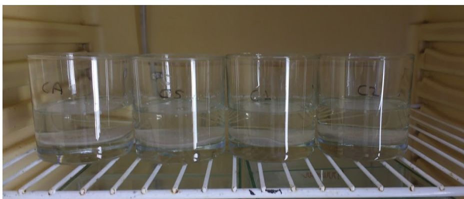
FIGURA 3. Bioensaio agudo de 48 horas, demonstrando a disposição dos frascos de vidro na câmara de germinação (BOD).
