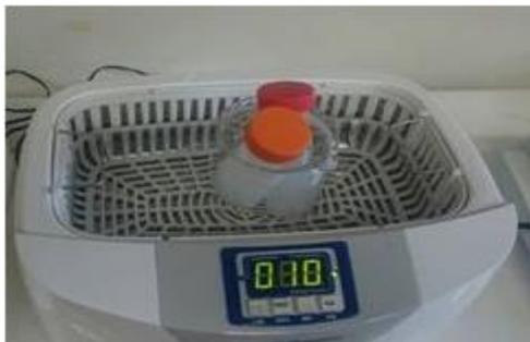
**Figura 3.** Suspensões de NPTiO<sub>2</sub> em banho sonicador para evitar agregação.
