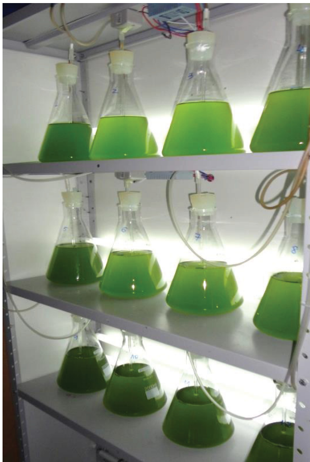
FIGURA 09 – CULTIVOS COM MICROALGA Scenedesmus sp. EM MEIO CHU E EFLUENTE DE BOVINOCULTURA
