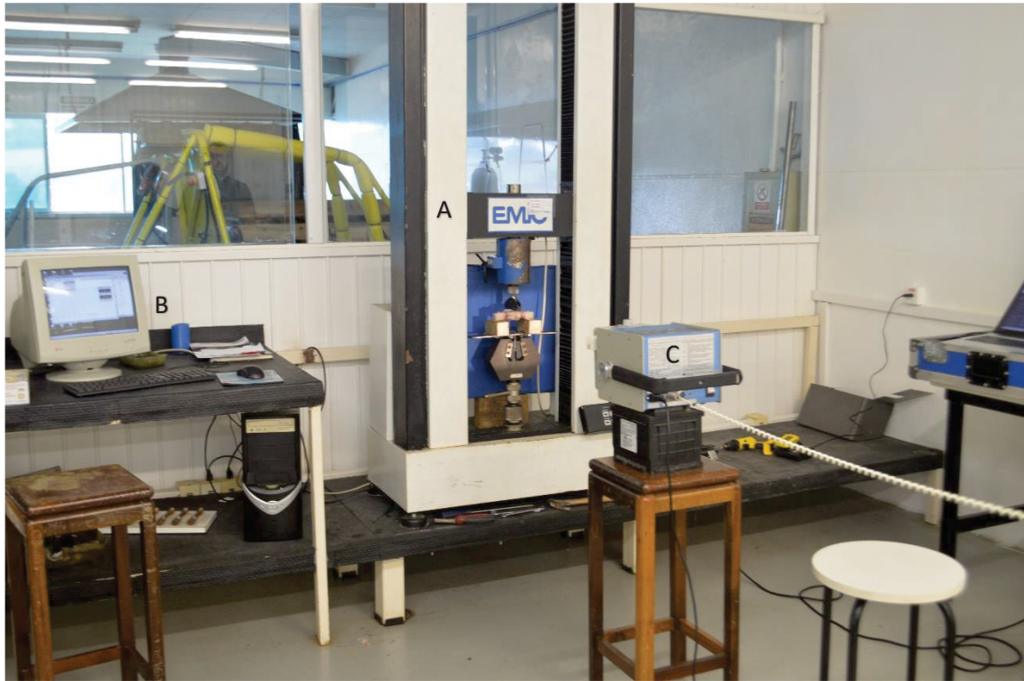
Figura 3.1. Laboratório de Ciências dos Materiais onde foi realizado o ensaio biomecânico comparativo ex vivo de coluna lombar de cão e coelho. Observar em A- Máquina Universal de Ensaio da EMIC®; B- Computador com software de ensaios da EMIC®; C- Raio-X portátil.
