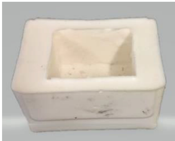
Figura 3.2. Molde de silicone utilizado para fazer bloco de resina acrílica autopolimerizável na extremidade cranial (L2-L3) e caudal (osso sacro) para fixar segmento de coluna vertebral lombar em Máquina de Ensaio Universal EMIC® e realizar estudo biomecânico ex vivo comparativo entre cão e coelho.
