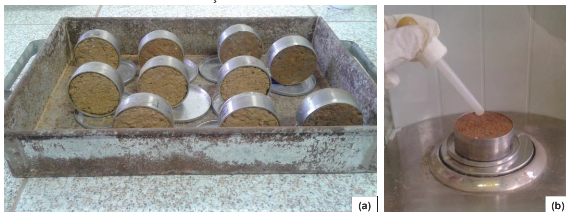
FIGURA 32 - CORREÇÃO DA UMIDADE DOS CORPOS DE PROVA
