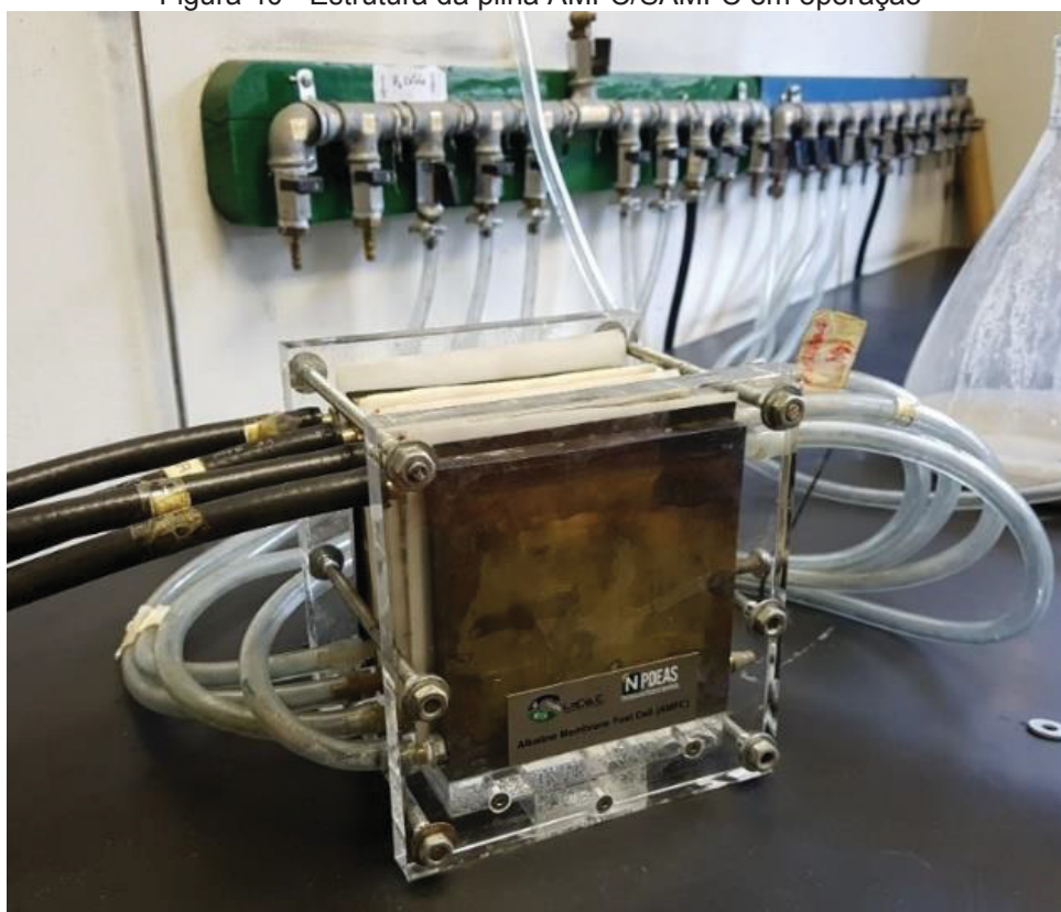
Figura 40 - Estrutura da pilha AMFC/SAMFC em operação
