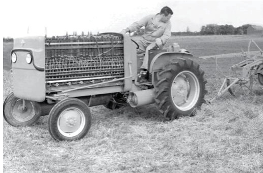
Figura 1 - Trator Allis-Chalmers com célula de combustível alcalina de 15 kW.
