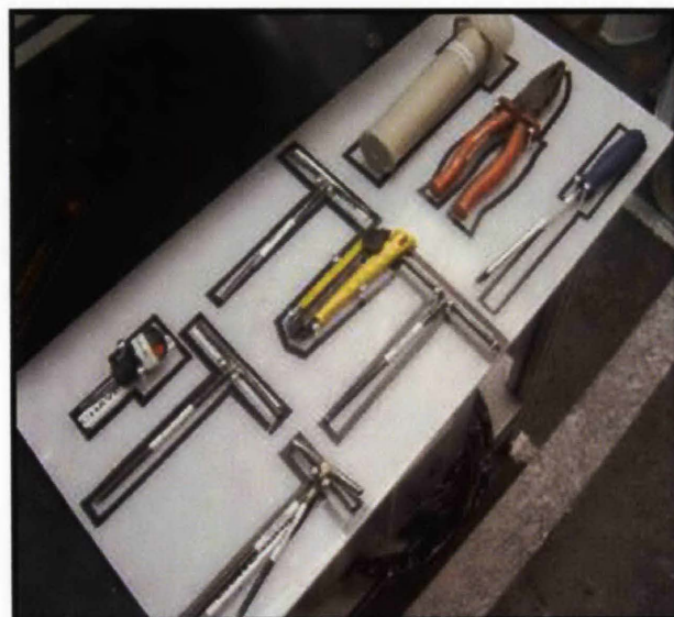
Foto 14 - O Shadow Board , um quadro com ferramentas de trabalho organizadas e identificadas.
