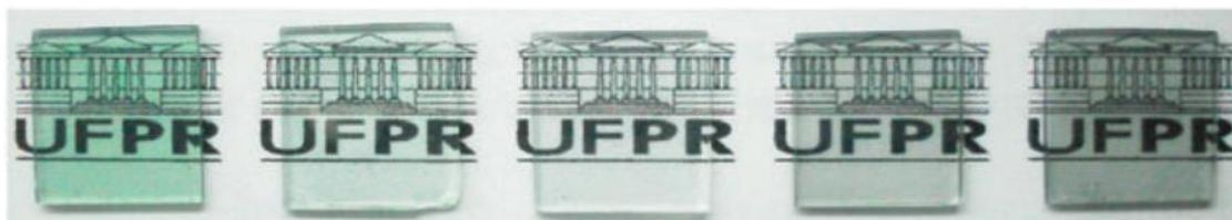
Figura 16 – Fotografia de filmes de rGO:PANI depositados sobre substratos de vidro. A quantidade de grafeno aumenta da esquerda para a direita. Adaptado de [24].
