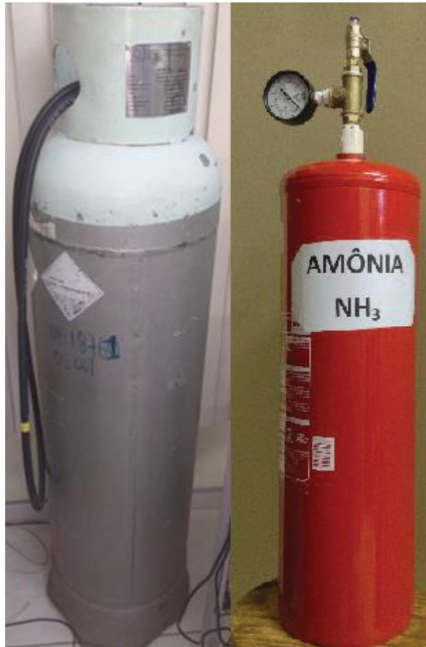
Figura 25 – a) Cilindro amônia anidra e b) Cilindro secundário com concentração conhecida de amônia em ar.
