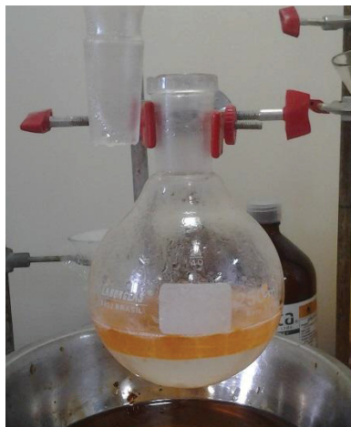
FIGURA 14 - BALÃO ONDE OCORREU A REAÇÃO DE EPOXIDAÇÃO. FASE SUPERIOR CONTÉM O ÓLEO DE MILHO E A FASE INFERIOR, UMA MISTURA DE ÁCIDO FÓRMICO COM PERÓXIDO DE HIDROGÊNIO.
