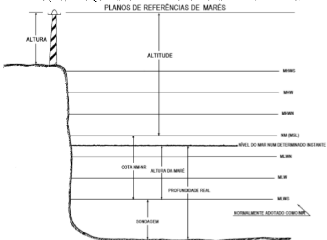
FIGURA 3 – NÍVEIS DE MARÉ E PLANOS DE REFERÊNCIA. ONDE MHWS É A MÉDIA DAS PREAMARES DE SIZÍGIA, MHW É A MÉDIA DAS PREAMARES OU ALTURA MÉDIA DAS PREAMARES AO LONGO DE UM DETERMINADO PERÍODO E MHWN É A MÉDIA DAS PREAMARES DE QUADRATURA. MLWN MÉDIA DAS BAIXA-MARES DE QUADRATURA, MLW É A MÉDIA DAS BAIXA-MARES OU ALTURA MÉDIA DAS BAIXA-MARES E MLWS É A MÉDIA DAS BAIXA-MARES DE SIZÍGIA. NR É O NÍVEL DE REDUÇÃO, PELO QUAL SÃO REFERIDAS TODAS AS DEMAIS MEDIDAS.
