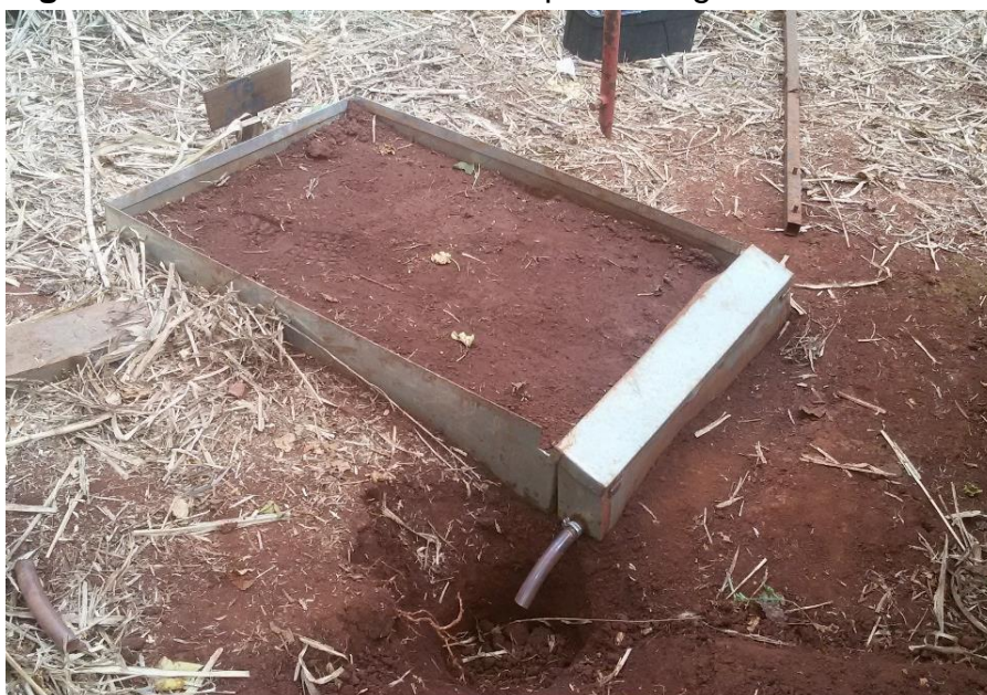
Figura 4 - Calha instalada no campo e mangueira de escoamento
