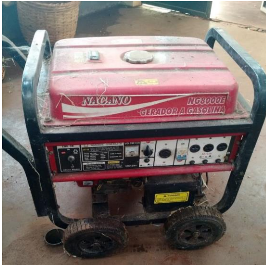
Figura 6 - Gerador de energia a gasolina
