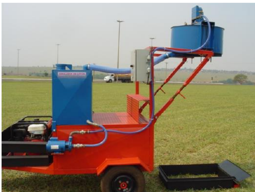
Figura 5 - Simulador de chuvas InfiAsper/UFMS
