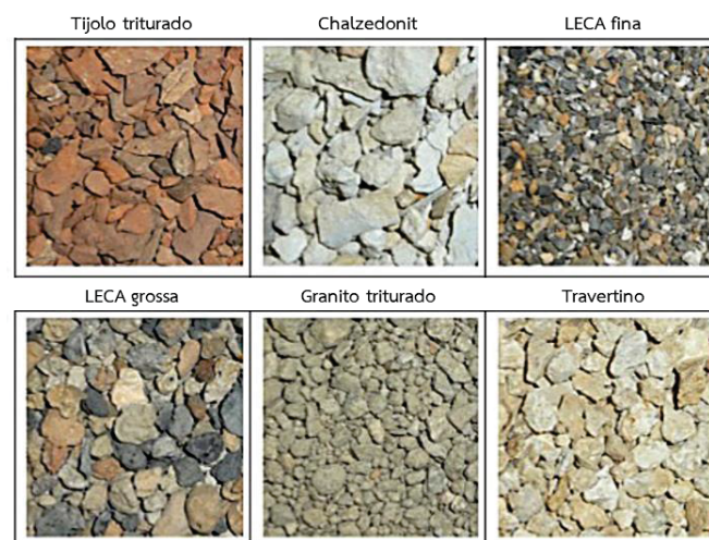
Figura 11 – Materiais drenantes utilizados por Gwózdź et al. (2016)
