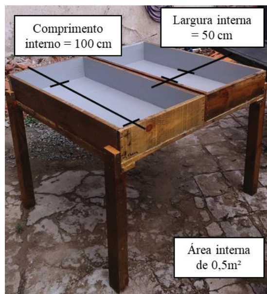
Figura 17 – Dimensões dos protótipos tipo 1
