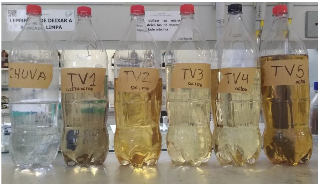
Figura 74 - Coleta das amostras de escoamento do Evento de chuva 12 – coleta dia 06/06/2018
