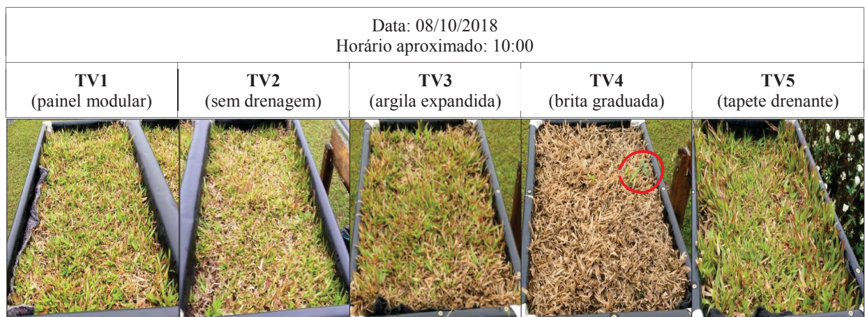
Figura 51 - Condição da camada vegetal no dia 08/10, com identificação do aparecimento de vegetação espontânea no protótipo TV4
