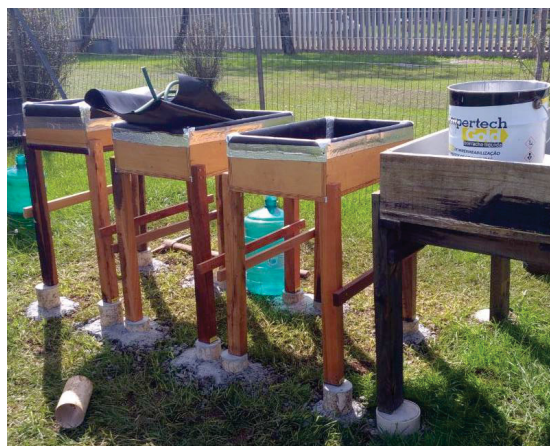
Figura 20 – Suporte de canos de PVC concretados para recebimento dos protótipos
