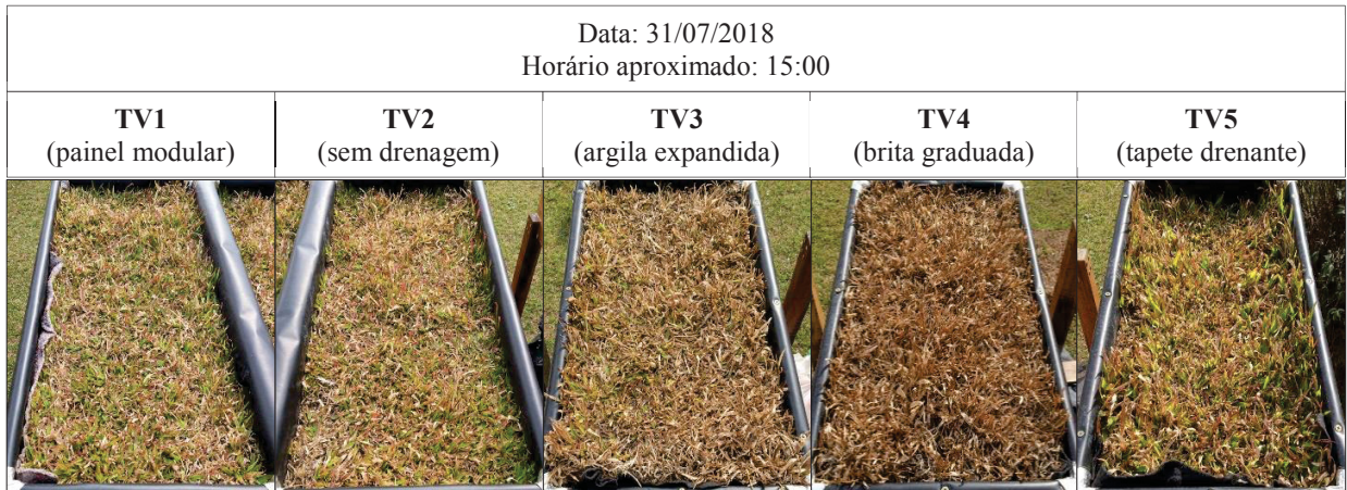
Figura 42 – Degradação da camada vegetal observado a partir de 31/07
