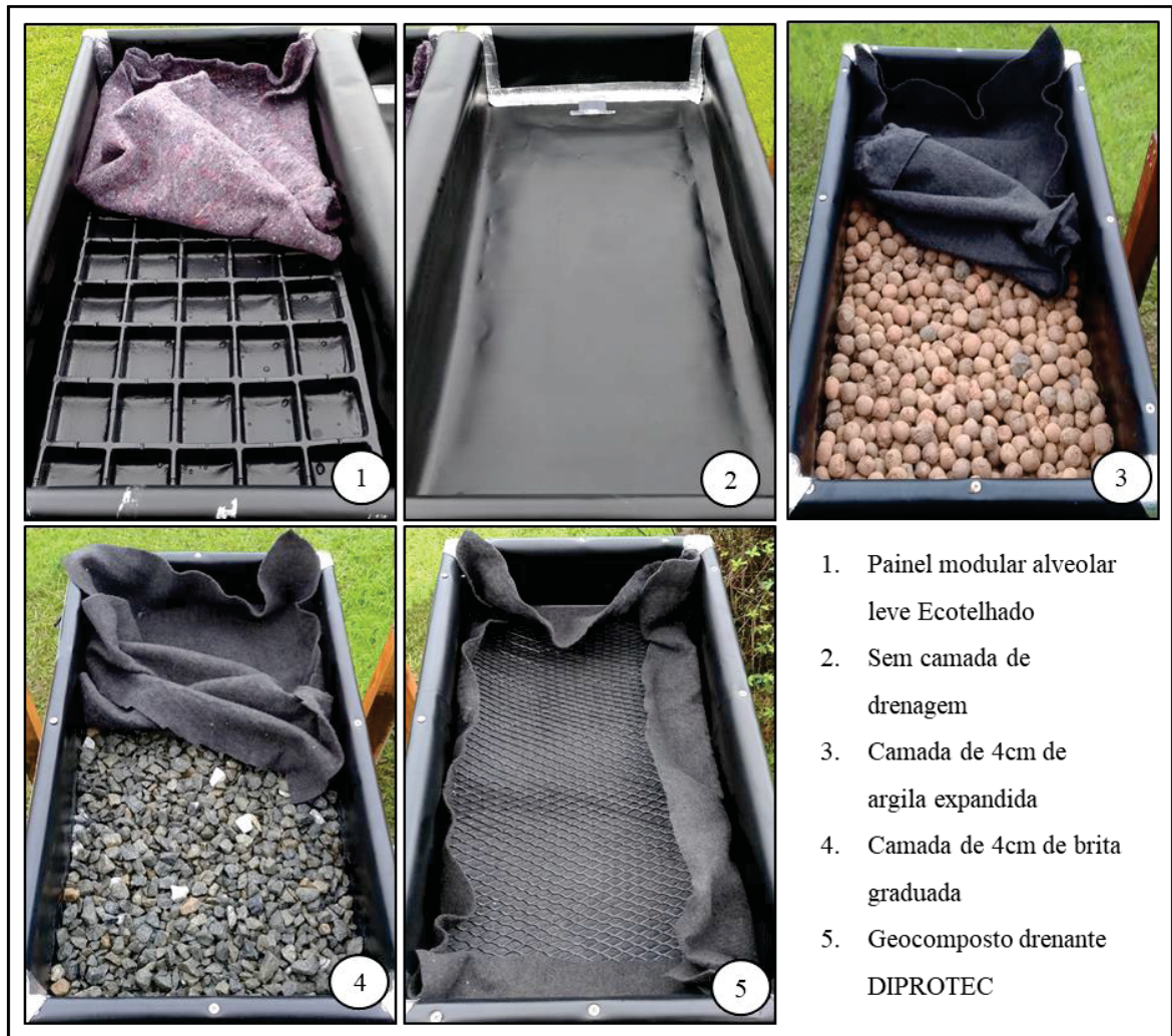
Figura 21 – Materiais drenantes utilizados nos protótipos
