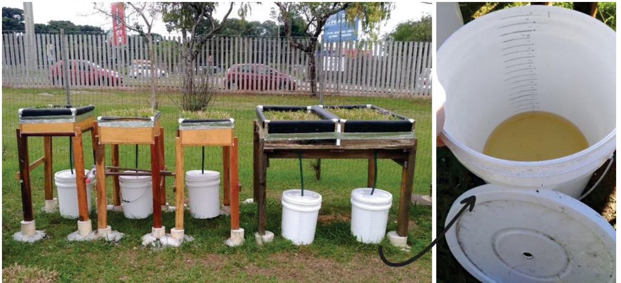
Figura 27 – Recipientes coletores instalados
