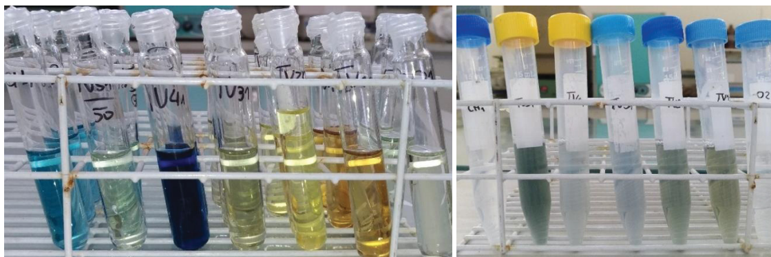
Figura 91 – Coloração de leitura apresentada para os parâmetros de nitrogênio amoniacal total e ortofosfato da coleta do dia 21/01
