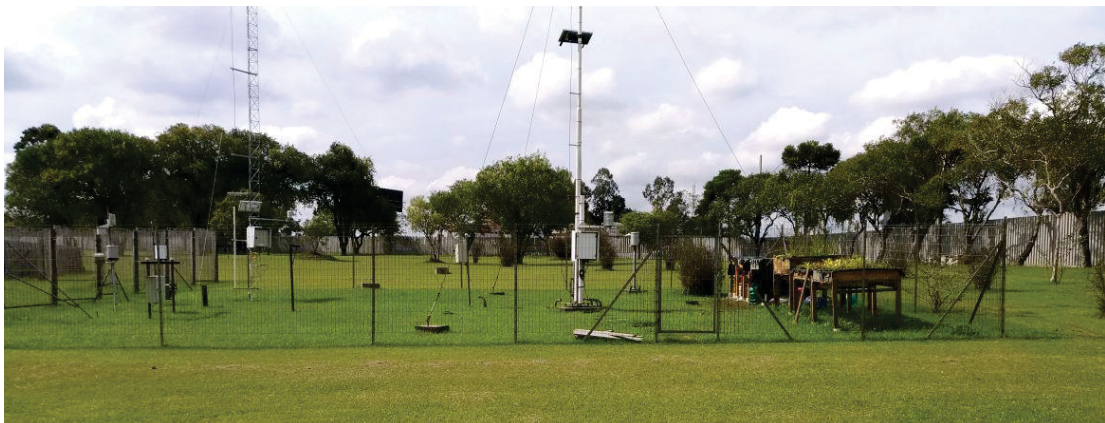
Figura 16 – Estação meteorológica automática INMET e telhados instalados
