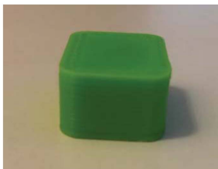
FIGURA 36 – RUN 5 REPLICAÇÃO 5, ALTURA DA CAMADA: 0,2MM, PADRÃO DE PREENCHIMENTO: RECTILINEAR, PORCENTAGEM DE PREENCHIMENTO: 100%, TEMPERATURA DE EXTRUSÃO: 235°C – VISTA LATERAL
