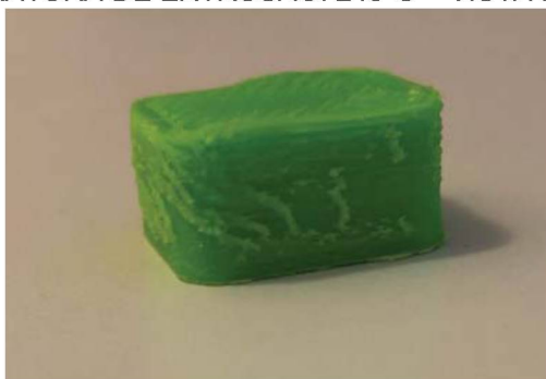
FIGURA 33 – RUN 3 REPLICAÇÃO 4, ALTURA DA CAMADA: 0,1MM, PADRÃO DE PREENCHIMENTO: HONEYCOMB, PORCENTAGEM DE PREENCHIMENTO: 100%, TEMPERATURA DE EXTRUSÃO: 245°C – VISTA FRONTAL
