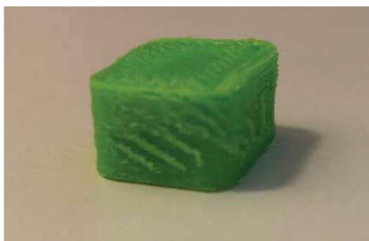
FIGURA 34 – RUN 3 REPLICAÇÃO 4, ALTURA DA CAMADA: 0,1MM, PADRÃO DE PREENCHIMENTO: HONEYCOMB, PORCENTAGEM DE PREENCHIMENTO: 100%, TEMPERATURA DE EXTRUSÃO: 245°C – VISTA LATERAL
