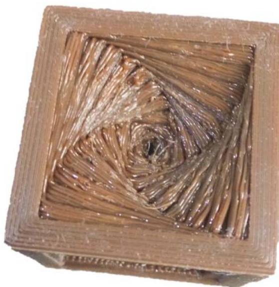
FIGURA 6 – ADIÇÃO DE CAMADAS SEM SUPORTE
