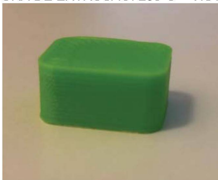
FIGURA 35 – RUN 5 REPLICAÇÃO 5, ALTURA DA CAMADA: 0,2MM, PADRÃO DE PREENCHIMENTO: RECTILINEAR, PORCENTAGEM DE PREENCHIMENTO: 100%, TEMPERATURA DE EXTRUSÃO: 235°C – VISTA FRONTAL
