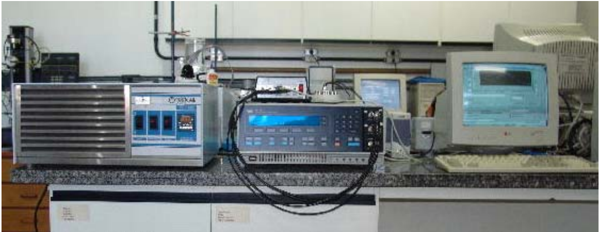
FIGURA 2 - LÍNGUA ELETRÔNICA DESENVOLVIDA PELA EMBRAPA
