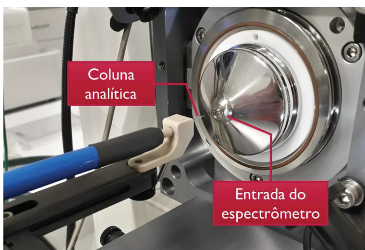
FIGURA 10 – COLUNA ANALÍTICA EM FRENTE À ENTRADA DO ESPECTRÔMETRO DE MASSAS LTQ Orbitrap XL ®
