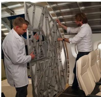
Figura 59: Partição interior para aeronaves A320 da Airbus
