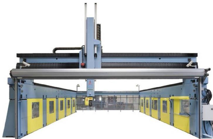
Figura 28: impressora 3D para metal - 500 metros cúbicos
