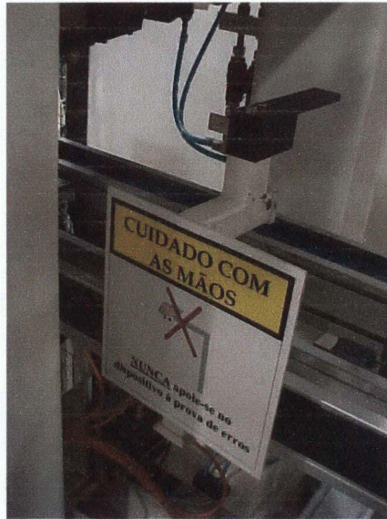
FIGURA 10.2.2 - Exemplo de poka-yoke de advertência - cortinas de luz que impedem a falta de montagem ou montagem peça incorreta
