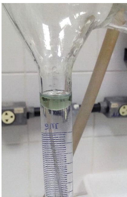
FIGURA 5 – ÓLEO EXTRAÍDO COM APARELHO GRADUADO TIPO CLEVANGER.
