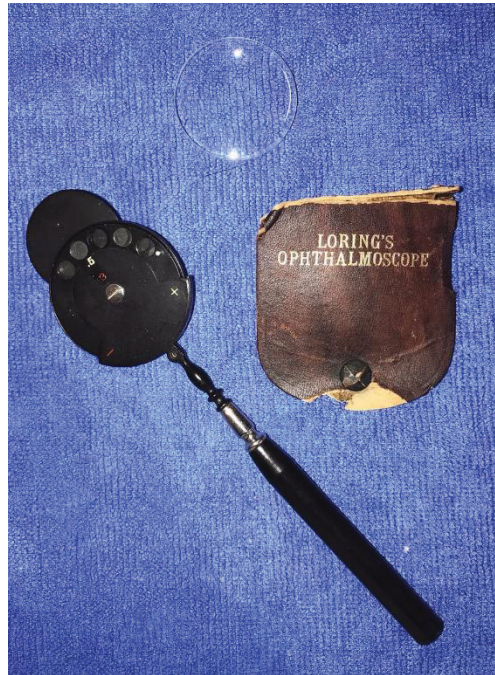
Figura 1 - Oftalmoscópio de Loring. Note a simplicidade do terceiro modelo produzido. Normalmente, vinha acompanhado de uma lente. Do outro lado do seletor de lentes do instrumento havia um espelho. Fonte: os autores.
