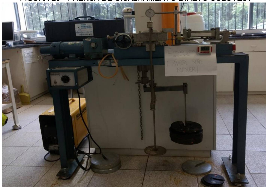
FIGURA 23 - PRENSA DE CISALHAMENTO DIRETO SOLOTEST
