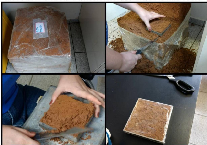
FIGURA 24 - MOLDAGEM DE CORPO DE PROVA PARA ENSAIO DE CISALHAMENTO DIRETO.
