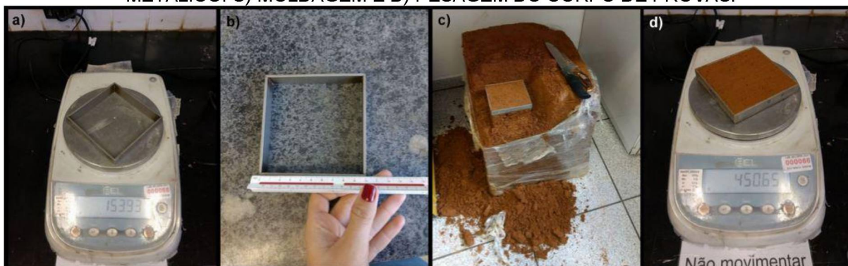
FIGURA 19 – PESO ESPECÍFICO DO SOLO: A) PESAGEM E B) MEDIÇÃO DO MOLDE METÁLICO. C) MOLDAGEM E D) PESAGEM DO CORPO DE PROVAS.
