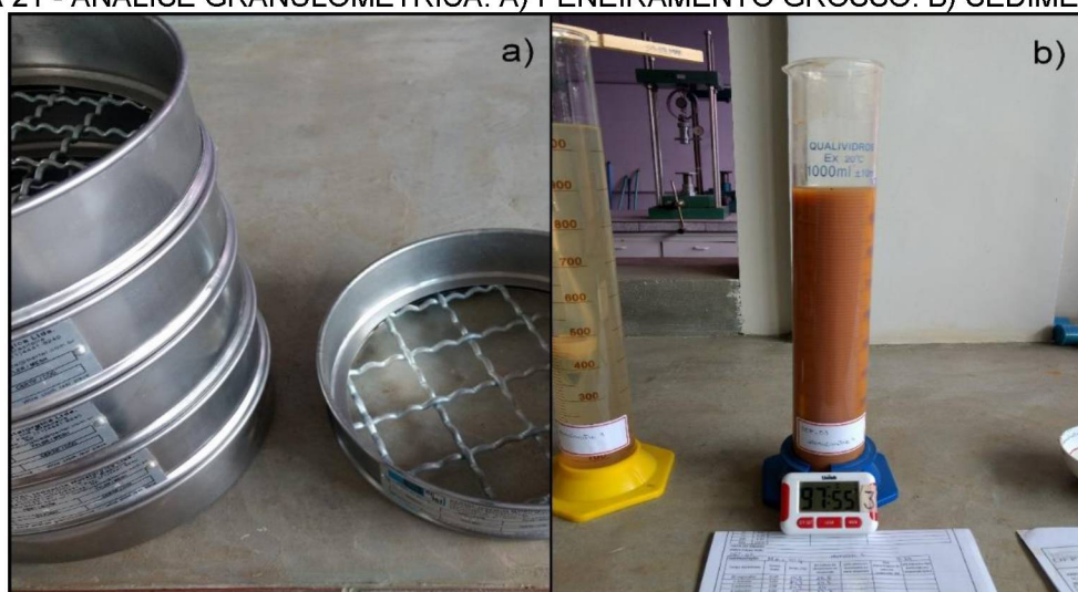
FIGURA 21 - ANÁLISE GRANULOMÉTRICA: A) PENEIRAMENTO GROSSO. B) SEDIMENTAÇÃO.
