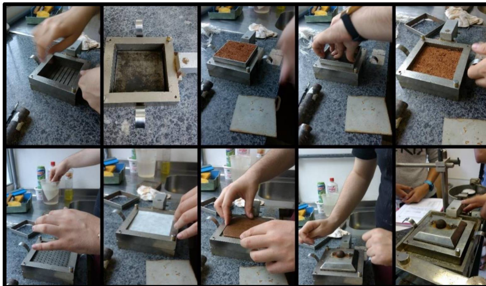
FIGURA 26 - MONTAGEM DA CÉLULA PARA ENSAIO DE CISALHAMENTO DIRETO RESIDUAL
