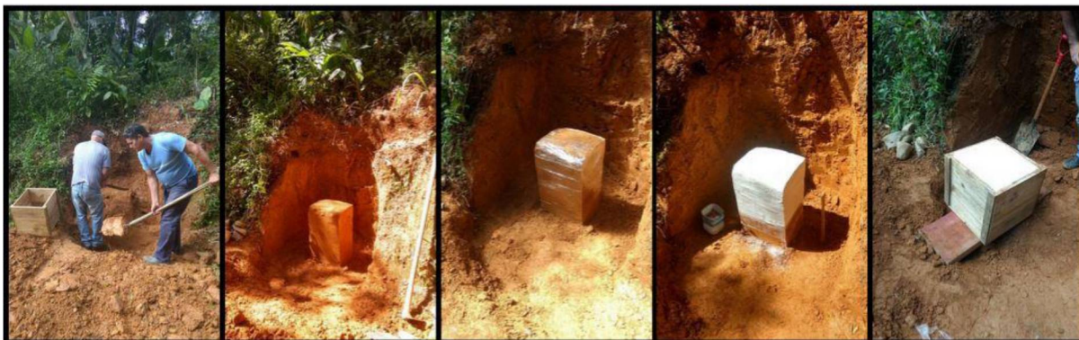
FIGURA 17 - PROCEDIMENTO DE COLETA DE AMOSTRA INDEFORMADA
