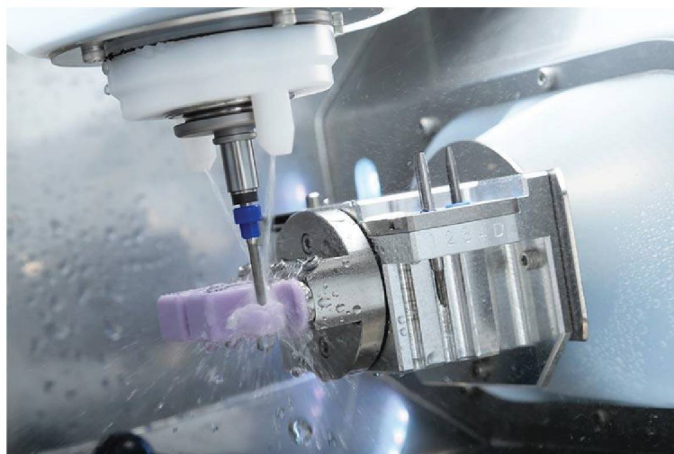
FIGURA 11 - EQUIPAMENTO REALIZANDO USINAGEM DE PRÓTESE COM SPRAY LÍQUIDO
