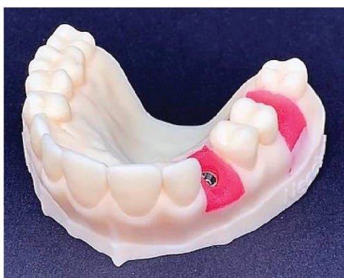
FIGURA 13 – MODELO IMPRESSO ATRAVÉS DA TÉCNICA DLP.
