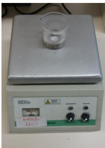
Figura 8 - Homogeneização do solo como agitador magnético. Fonte: O autor (2016)
