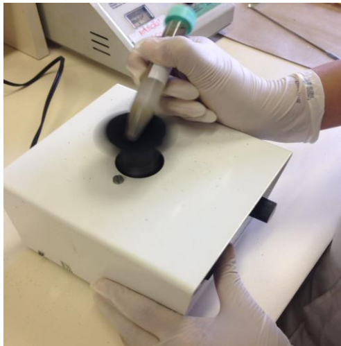
Figura 7 - Etapa de homogeneização do solo utilizando o aparelho vórtex. Fonte: A autora (2016)
