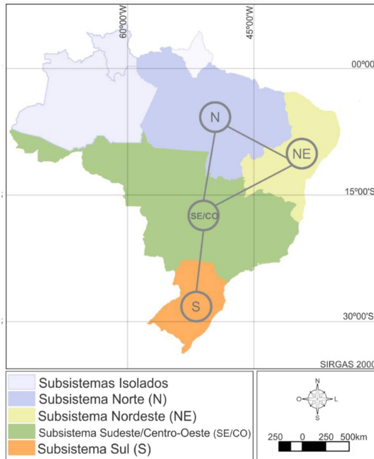
FIGURA 3 – INTERLIGAÇÃO DOS SUBSISTEMAS ELÉTRICOS NO BRASIL
