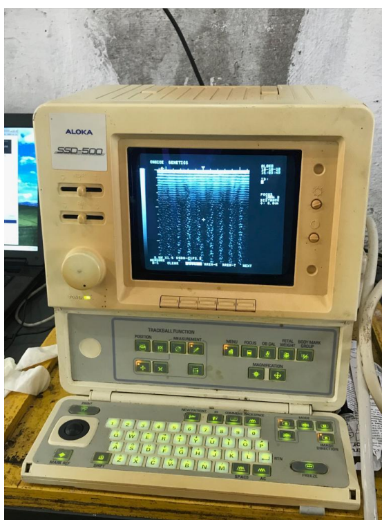
Figura 12- Aparelho de ultrassom utilizado na avaliação da espessura de toucinho no teste de seleção. Fonte: Bruna Sperotto.
