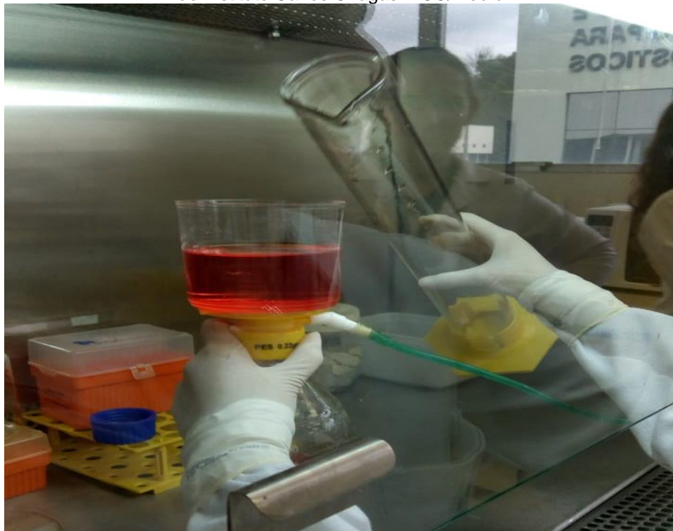
FIGURA 7 - Processo de filtração do meio RPMI-1640 em sistema a vácuo com membrana filtrante de 0,22\mu\text{m} no fluxo laminar do Laboratório de Biologia Celular do Instituto Carlos Chagas - ICC/Fiocruz.
