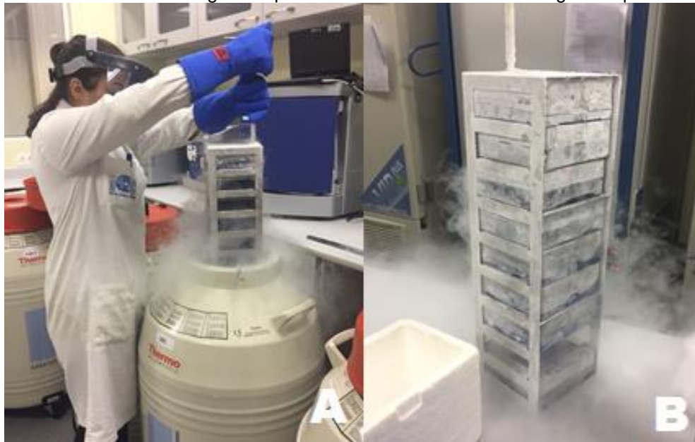
FIGURA 9 - Processo de descongelamento de Leishmania braziliensis na sala de Freezers do Instituto Carlos Chagas – ICC/Fiocruz. A- Retirada da rack do interior do container de nitrogênio líquido B- rack do container de nitrogênio líquido.
