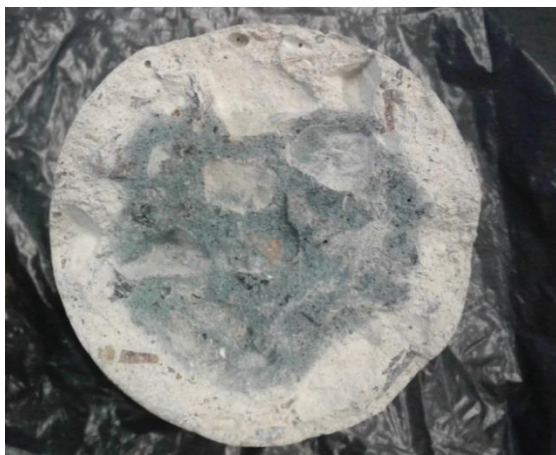
FIGURA 62 – ASPECTO VISUAL ANTES DA ASPERSÃO DE FENOLFTALEÍNA EM CORPO DE PROVA COM CIMENTO SUPERSULFATADO EXPOSTO À CARBONATAÇÃO POR 28 DIAS
