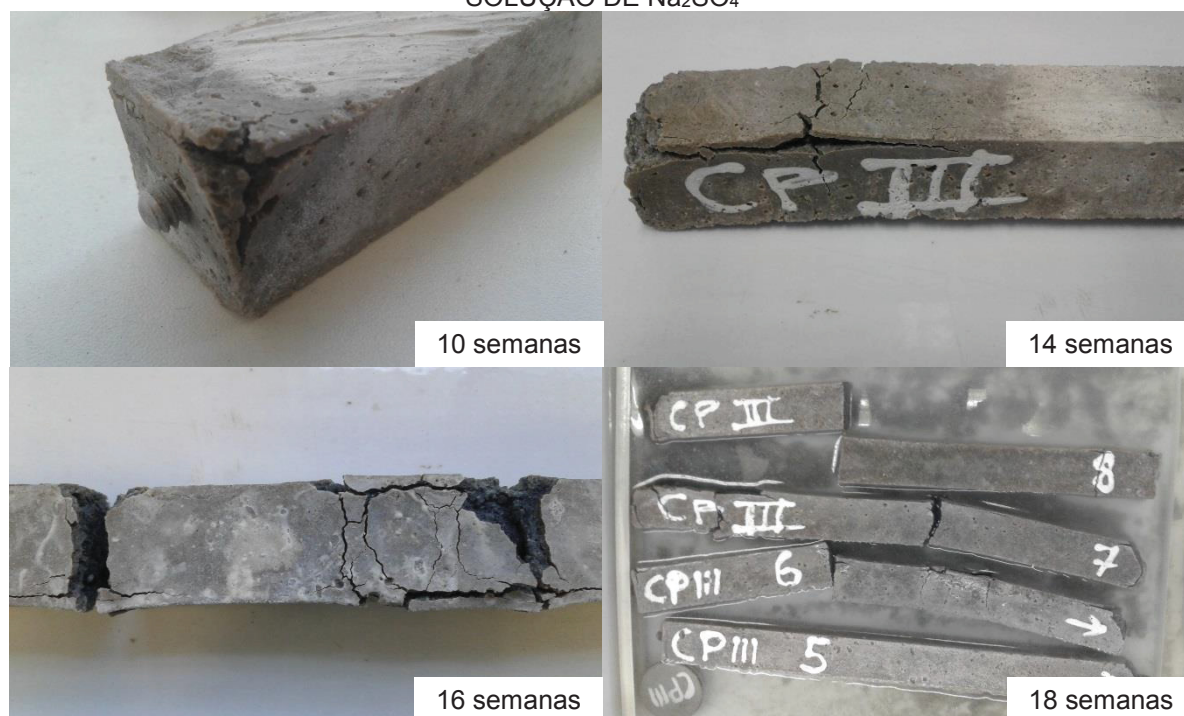
FIGURA 86 – INSPEÇÃO VISUAL DAS AMOSTRAS COM CIMENTO CP III RS EXPOSTAS À SOLUÇÃO DE \text{Na}_2\text{SO}_4
