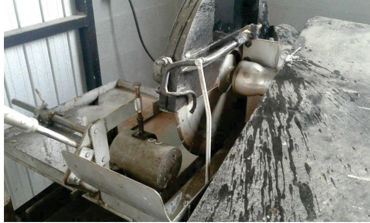
FIGURA 35 – PROCEDIMENTO DE CORTE COM SERRA CIRCULAR DIAMANTADA
