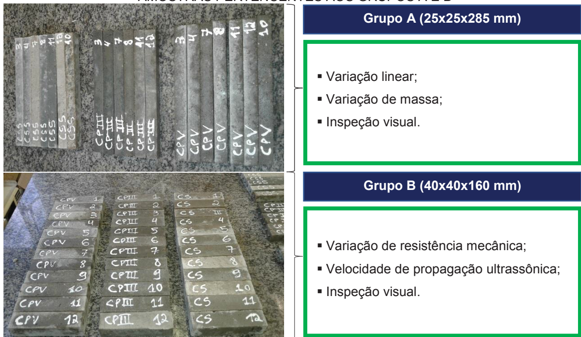
FIGURA 29 – REPRESENTAÇÃO ESQUEMÁTICA DOS ENSAIOS REALIZADOS A PARTIR DAS AMOSTRAS PERTENCENTES AOS GRUPOS A E B
