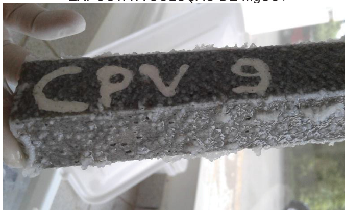
FIGURA 80 – FORMAÇÃO DE BRUCITA SOBRE A SUPERFÍCIE DA AMOSTRA CP V ARI EXPOSTA A SOLUÇÃO DE MgSO_4
