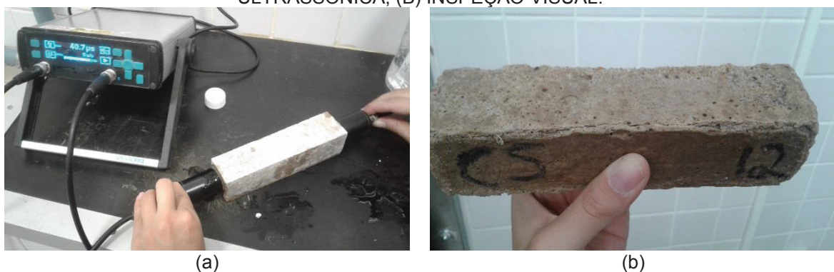
FIGURA 42 – ENSAIOS DO GRUPO B: (A) LEITURA DA VELOCIDADE DE PROPAGAÇÃO ULTRASSÔNICA, (B) INSPEÇÃO VISUAL.
