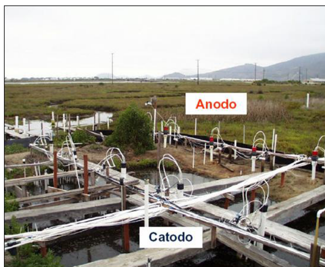
FIGURA 8 – EXEMPLO DE APLICAÇÃO PRÁTICA DA TÉCNICA DE REMEDIAÇÃO ELETROKINÉTICA PARA EXTRAÇÃO DE CROMO E CÁDMIO.
