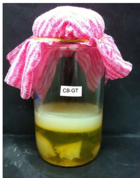
FIGURA 8. BIOFILME DE CELULOSE BACTERIANA OBTIDA NA COMPOSIÇÃO OTIMIZADA PARA O CHÁ VERDE
