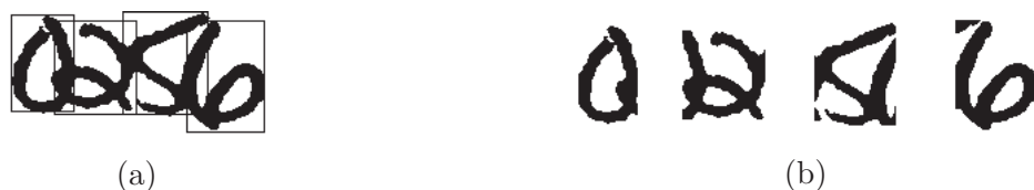
Figura 4.19: (a) Rotulação para a cadeia de 4-dígitos (0256) e (b) forma dos dígitos impactados pela vizinhança.
