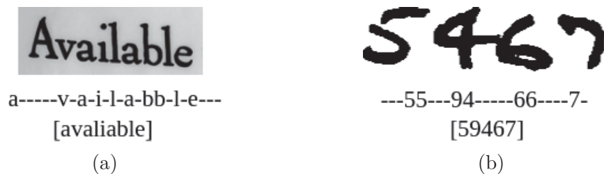
Figura 5.10: Saídas de uma Rede Neural Recorrente (Shi et al., 2017) aplicada a (a) palavras e (b) cadeia numérica.
