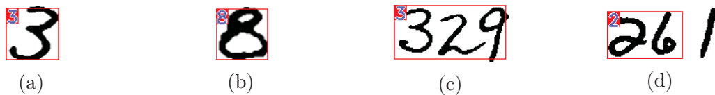
Figura 4.18: Detecções do modelo treinado a partir de dígito isolados (apenas): (a) e (b) representa a correta detecção de dígitos isolados, (c) e (d) são classificações errôneas causadas por aprendizado errôneo do contexto.
