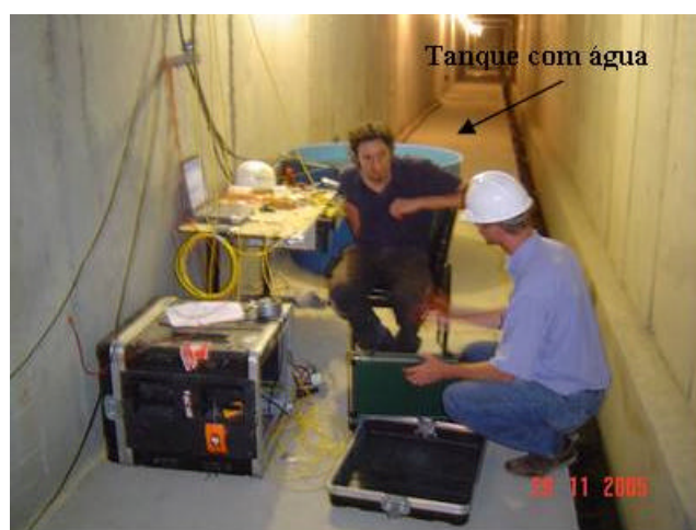
FIGURA 62 - DETALHE DO SISTEMA DE LEITURA SENSORES TFOR
