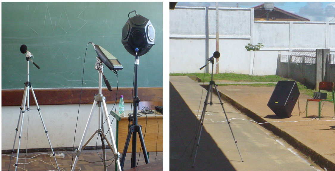
FIGURAS 9A E 9B – MEDIÇÃO ISOLAMENTO DE FACHADA – EQUIPAMENTOS DENTRO (DIREITA) E FORA (ESQUERDA) DA SALA DE AULA
