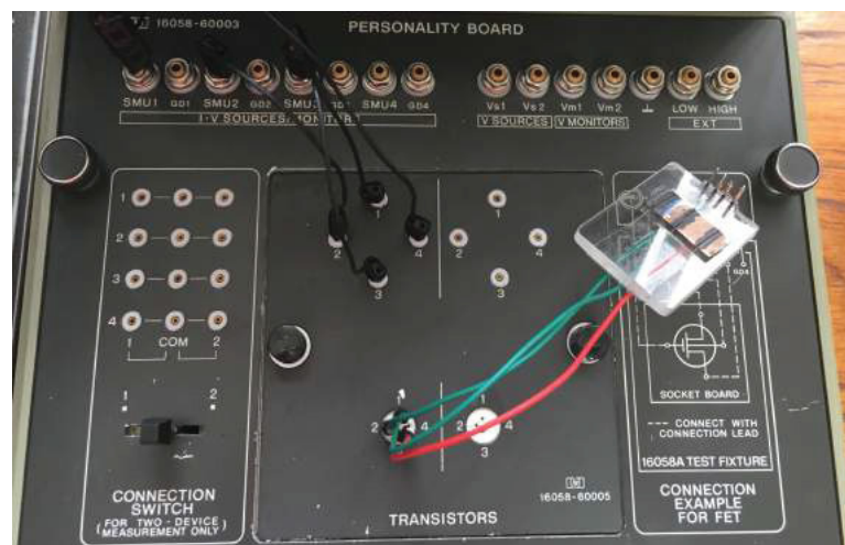
FIGURA 4.1: Conexão entre os terminais de um dos OFETs e o sistema de medição do Analisador de Parâmetros Agilent 4155C.
