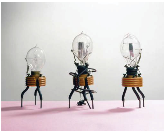
FIGURA 1.1: Válvula termiônica de John A. Fleming.
