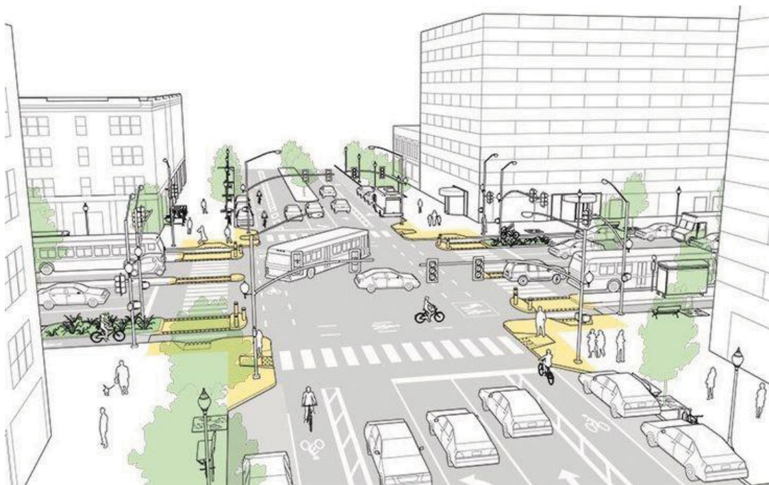
Figura 3. Desenho de um cruzamento de vias principais desenhado para a segurança de todos os usuários da via.
