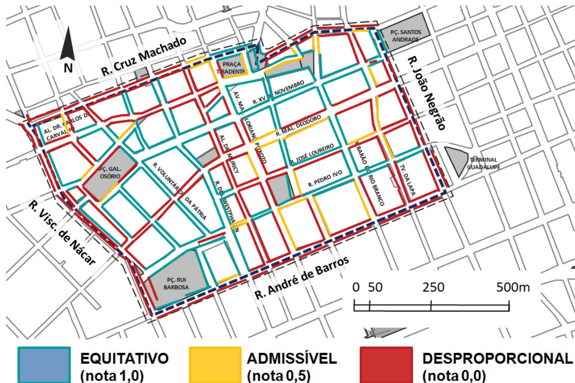
Cartograma 4 Avaliação da equidade na distribuição de espaço para a circulação de pedestres em relação à de veículos.
