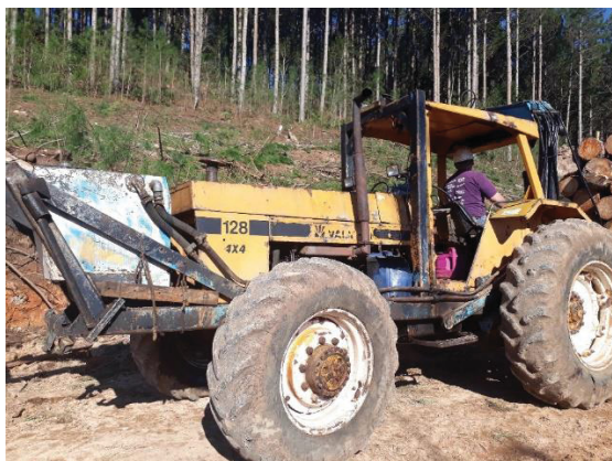
Figura 4. Carregador florestal “munck” adaptado em trator agrícola utilizado para empilhamento e carregamento das toras em veículos de transporte.
