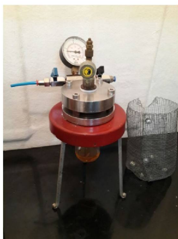
Figura 34: Imagem do reator utilizado para reações envolvendo médias pressões de gases.
