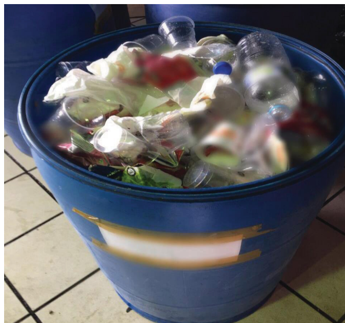
FIGURA 6 – BOMBONA DE 200L PREENCHIDA PARA O QUARTEAMENTO
