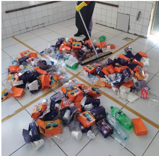
FIGURA 7 – QUARTEAMENTO PARA SELEÇÃO DE AMOSTRA
