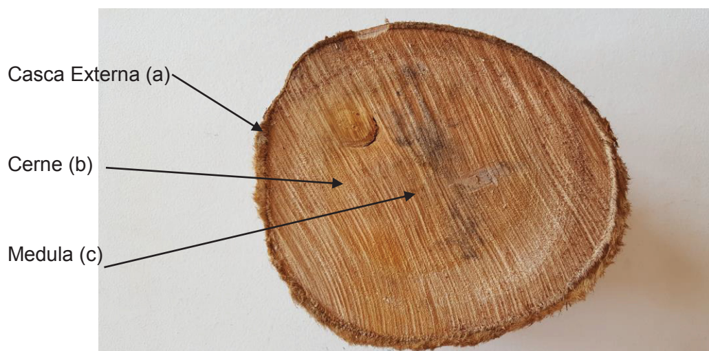
FIGURA 1 - CORTE TRANSVERSAL DO TRONCO, DEMONSTRANDO AS SECÇÕES DA CASCA EXTERNA (a), CERNE (b) E MEDULA (c).
