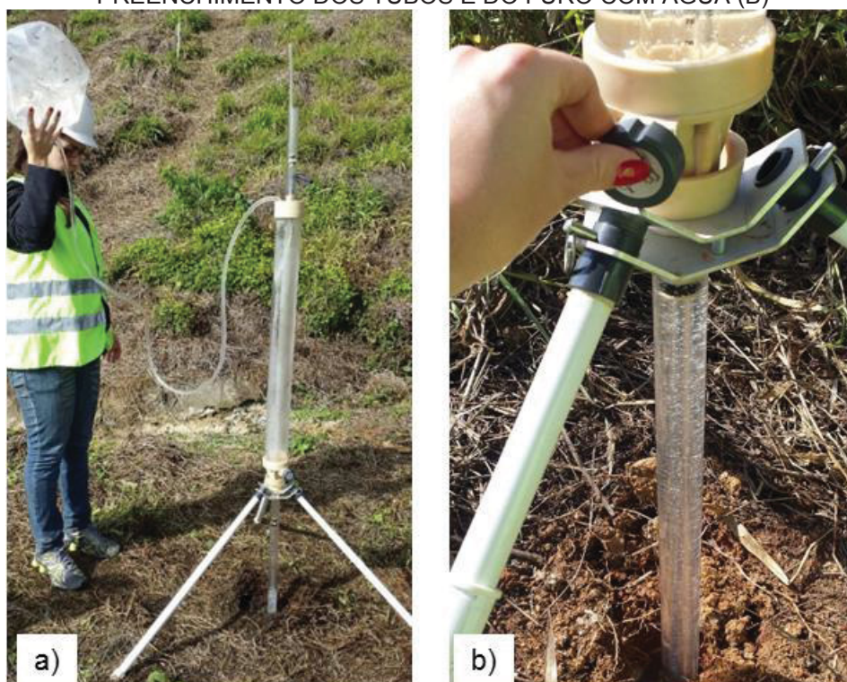
FIGURA 42 - EXECUÇÃO DO ENSAIO: ENCHIMENTO DO RESERVATÓRIO (A); PREENCHIMENTO DOS TUBOS E DO FURO COM ÁGUA (B)
