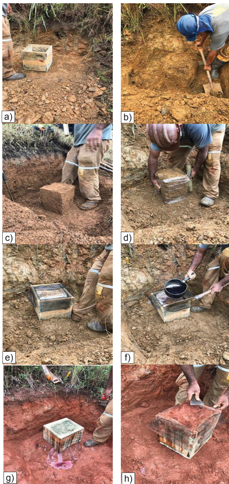
FIGURA 56 - PROCEDIMENTOS PARA RETIRADA DE BLOCOS INDEFORMÁVEIS
