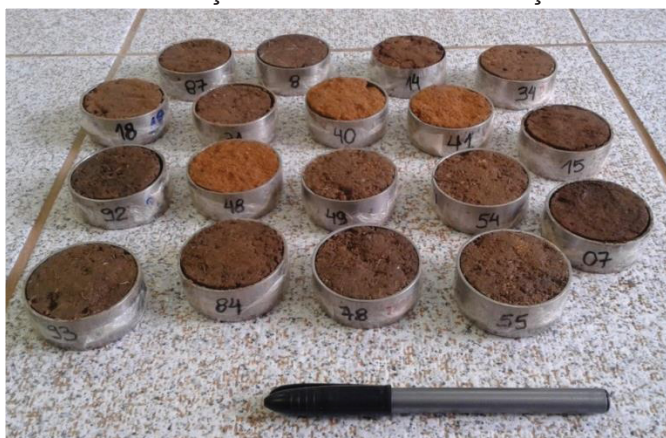
FIGURA 47 - AMOSTRAS INDEFORMADAS RETIRADAS DOS PONTOS DE COLETA PARA REALIZAÇÃO DO ENSAIO DE SUCÇÃO
