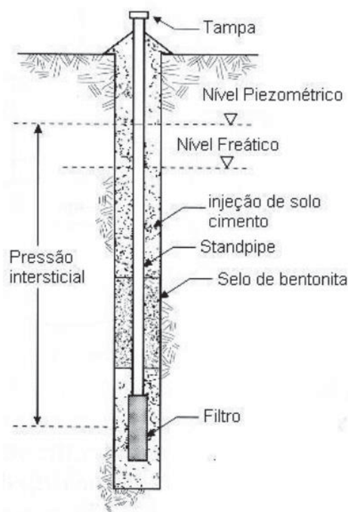
FIGURA 20 - ILUSTRAÇÃO DE PIEZÔMETRO STANDPIPE
