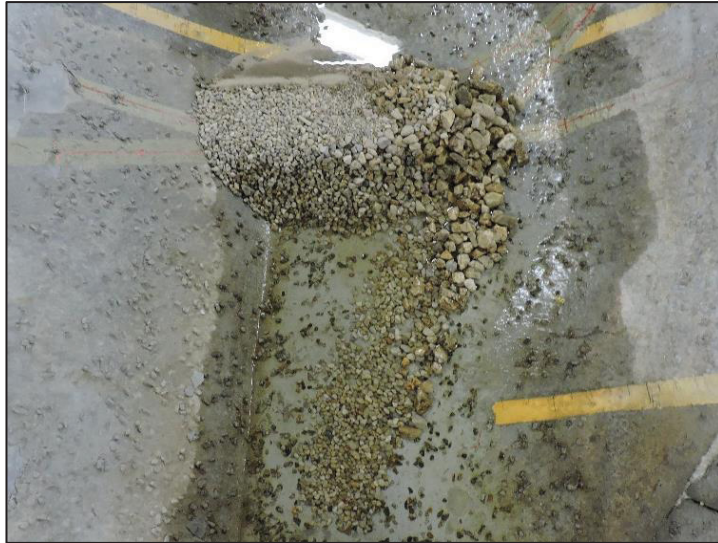
FIGURA 4.6 - CONFIGURAÇÃO DE LANÇAMENTO EFETUADO NO ENSAIO 04 COM DESTAQUE PARA O ARRASTE DE MATERIAL DE DIÂMETRO MAIOR
