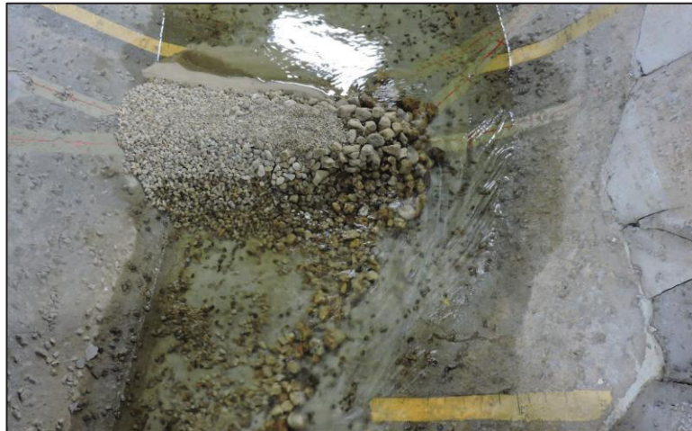
FIGURA 4.5 - CONFIGURAÇÃO FINAL DE LANÇAMENTO EFETUADO NO ENSAIO 03
