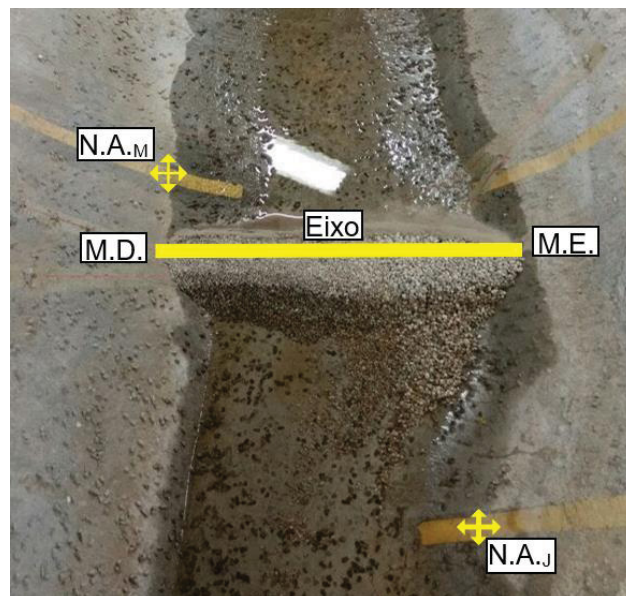
FIGURA 4.2 - VISTA SUPERIOR DA CALHA DO RIO - PONTOS DE OBTENÇÃO DE \Delta H .
