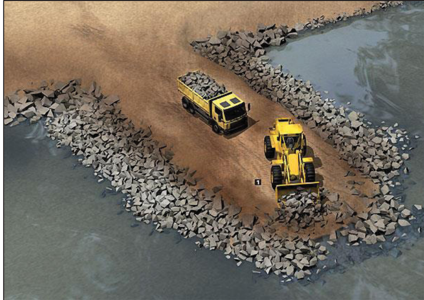
FIGURA 2.12 - ESQUEMA DA LANÇAMENTO EM PONTA DE ATERRO FONTE: CORSINI (2011)
