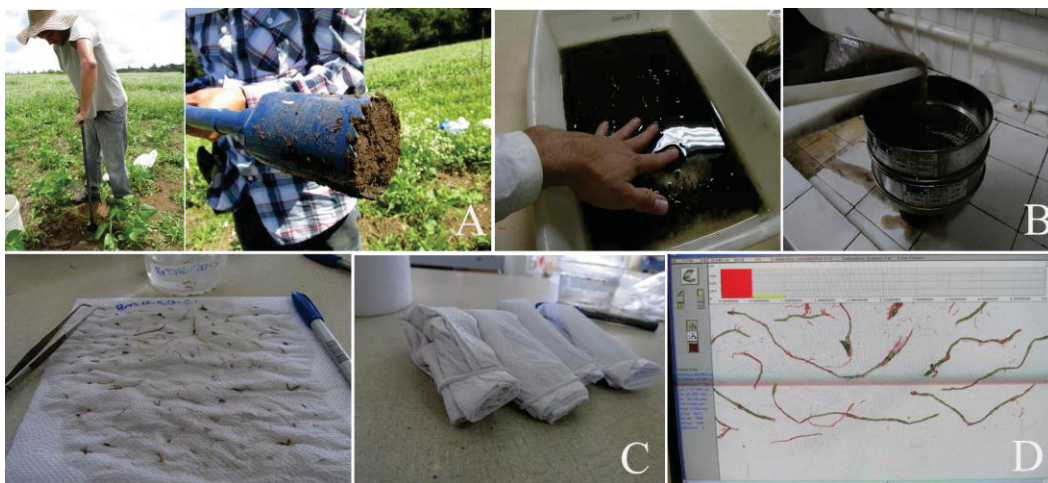
FIGURA 3. Amostragem de raízes. Coleta com trado (A), lavagem (B), secagem (C) e análise de raízes pelo software WinRhizo® (D).
