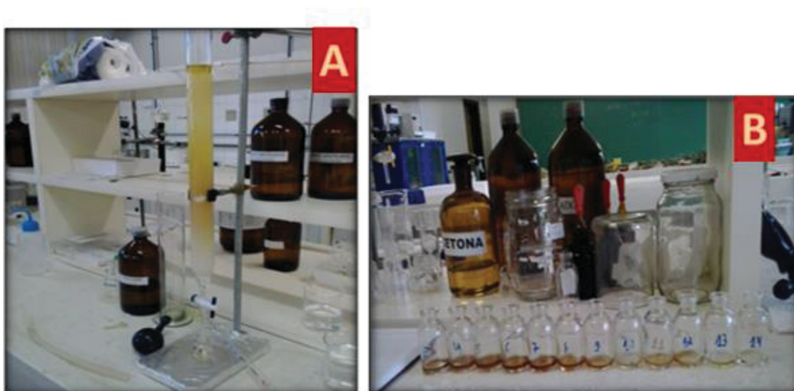
FIGURA 15 - A) COLUNA SEPHADEX DO EXTRATO DE DICLOROMETANO DAS SEMENTES DE ANNONA SALZMANNII , B) FRAÇÕES 1-15
