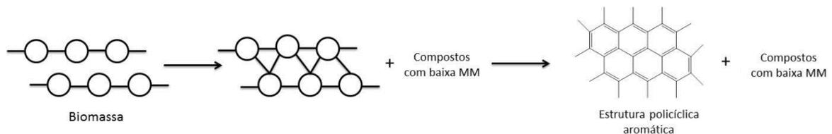
FIGURA 5 – Esquema referente à formação do *biochar* a partir da pirólise da biomassa. Legenda: MM: Massa Molecular. Fonte: Adaptado de Collard e Blin (2014).
