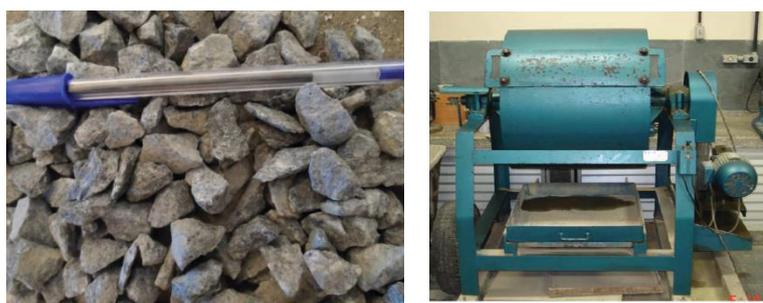
Figura 30: Agregado utilizado para o ensaio e britador Los Angeles (mesmo modelo utilizado para a britagem dos materiais)
