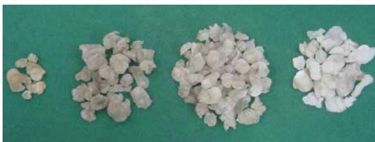
Figura 10: Aparência dos géis coletados na superfície do concreto de uma UHE afetado pela RAS (HASPARYK, 2005).
