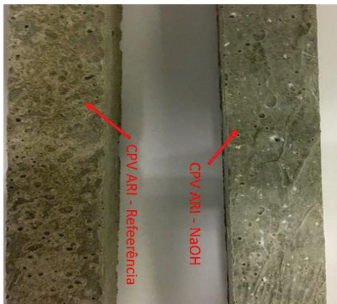
Figura 62: Barras de 100% cimento na solução de NaOH 80°C e no banho-maria com água destilada
