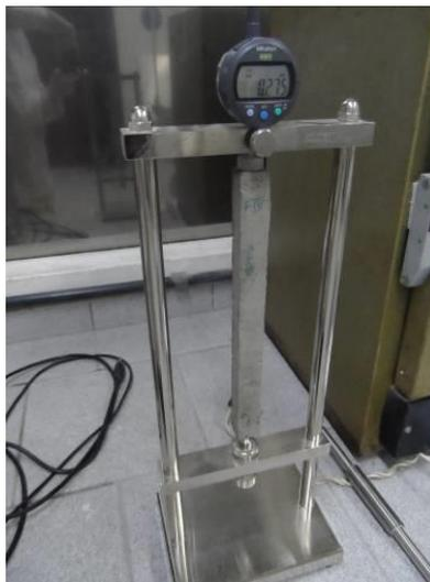
Figura 24: Dispositivo de monitoramento da variação dimensional com um relógio comparador de comprimento.
