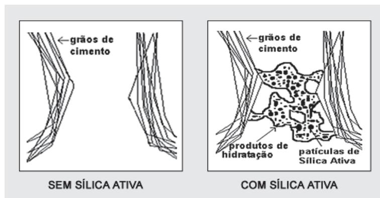
Figura 16: Redução de vazios com a utilização da sílica ativa (TECNOSIL, 2013).
