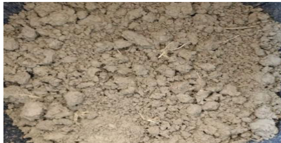
FIGURA 8 - LODO DE FLOTADOR
