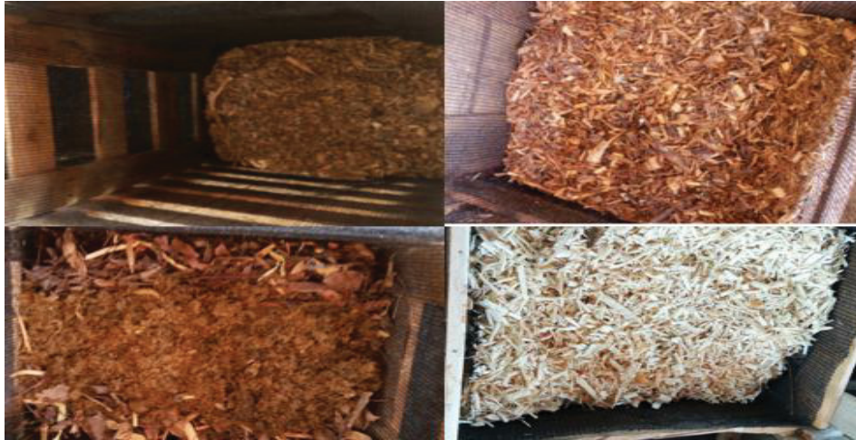
FIGURA 10 - MONTAGEM EM CAMADAS DE RESÍDUOS ORGÂNICOS NAS CÉLULAS DE COMPOSTAGEM.
